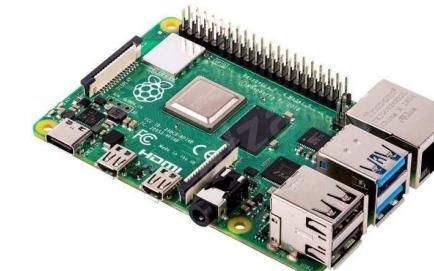
**Ábra 4:** Raspberry Pi 4 mikrovezérlő
