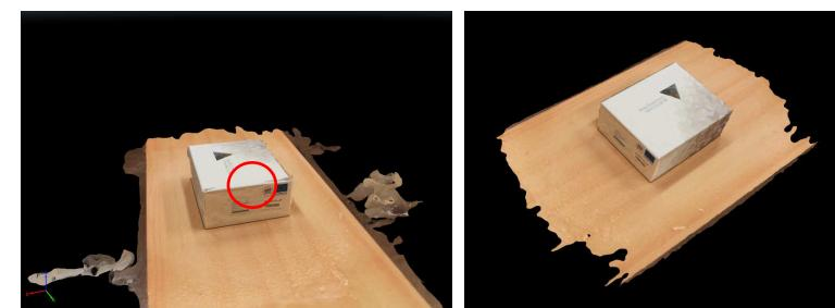
Obrázok 5: Model vytvorený z 250 fotozáberov – vľavo a upravený model – vpravo.
